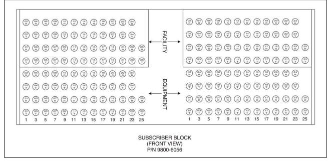
FIGURE 4-1: STANDARD CONNECTOR BLOCK
