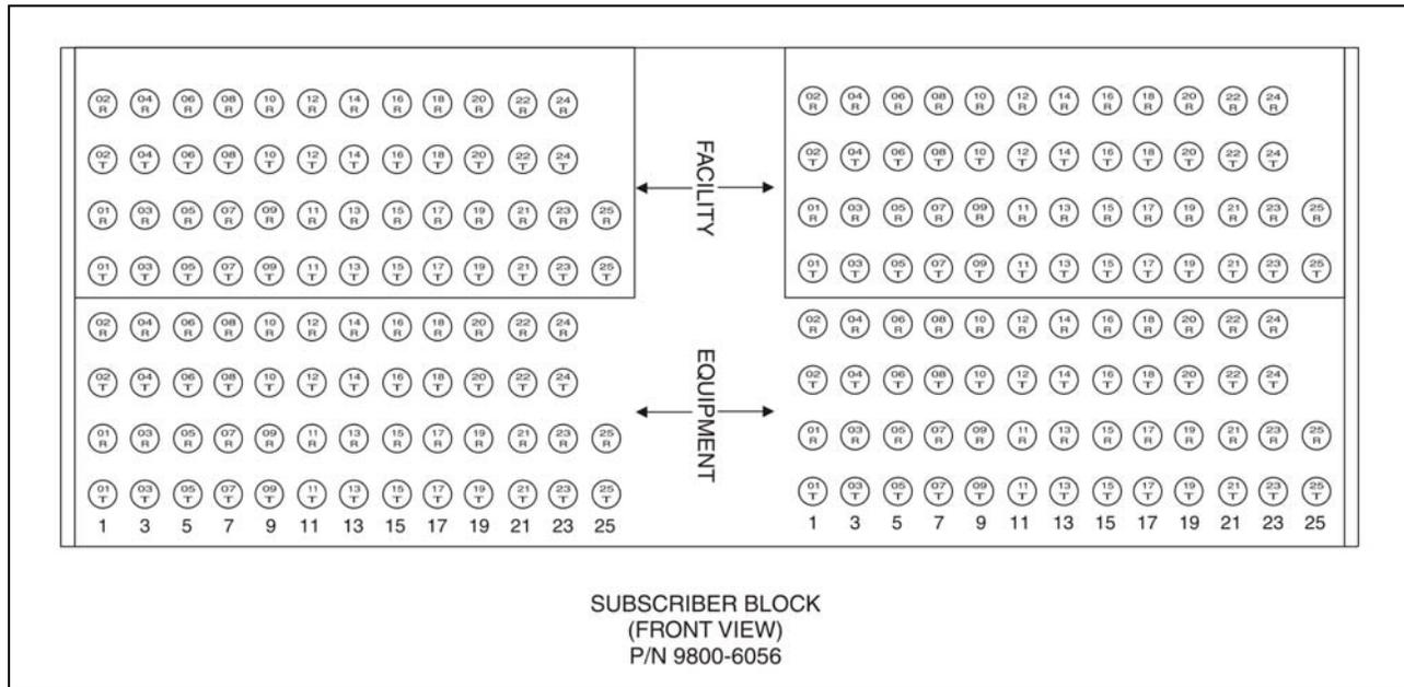
FIGURE 4-1: STANDARD CONNECTOR BLOCK
